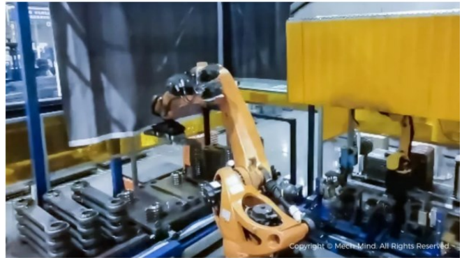
3D视觉引导钢板抓取&组对焊接
