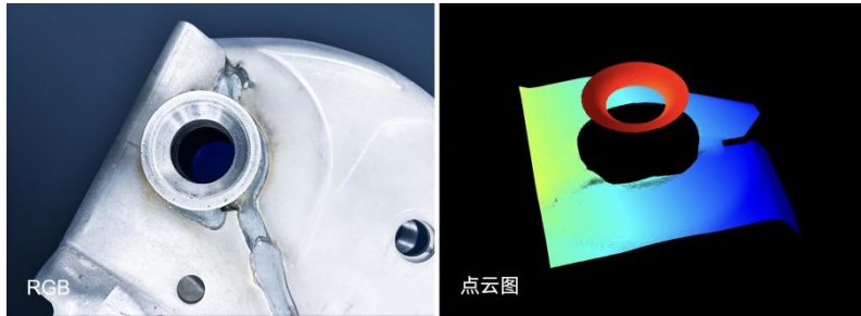
（反光圆孔，Mech-Eye UHP-140@0.3m，点云数据按高度渲染）
